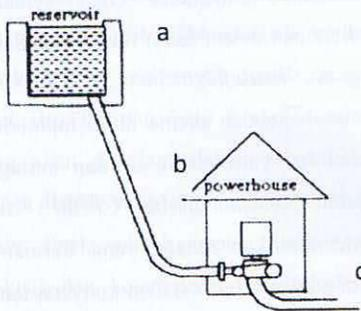
Gambar 1. Skema pembangunan sebuah PLTMH
